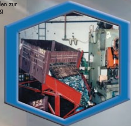
Trichterförmige Entladung auf das Fließband einer spanischen Automobilfabrik
