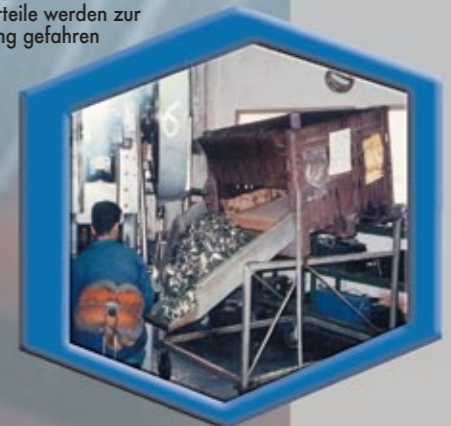
Maßgefertigte Box mit Ladeklappe, aus der vorsichtig die Teile auf das Fließband entladen werden
